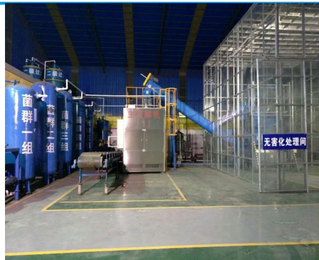
Hệ thống thùng lên men trực đơn và hệ thống đưa nguyên liệu xoắn ốc.
